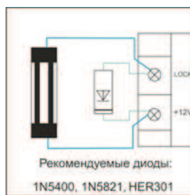
Рис.6 Установка защитного диода
