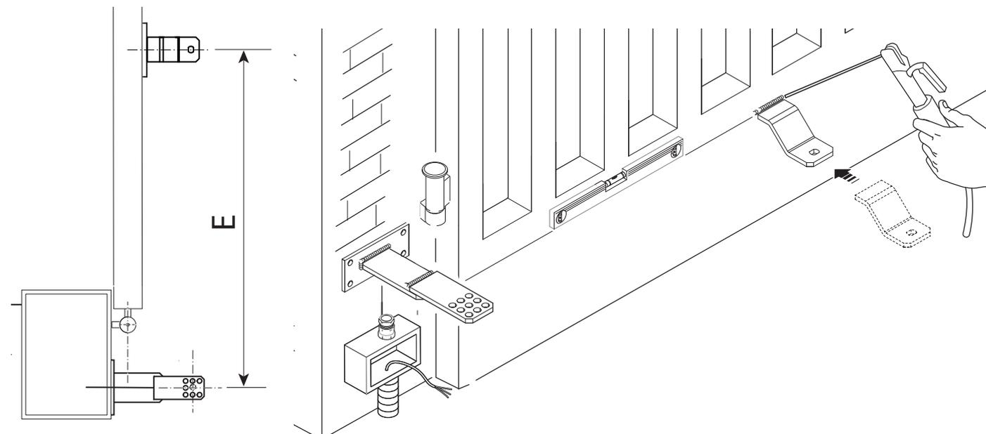
Закрепите привод на кронштейнах с помощью прилагаемых болтов и шайб.
