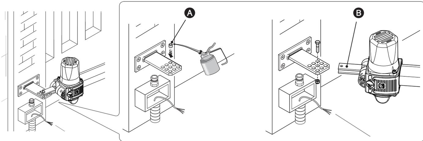
Откройте створку, вставьте стержень в отверстие переднего кронштейна и зафиксируйте его с помощью шайбы и гайки.
