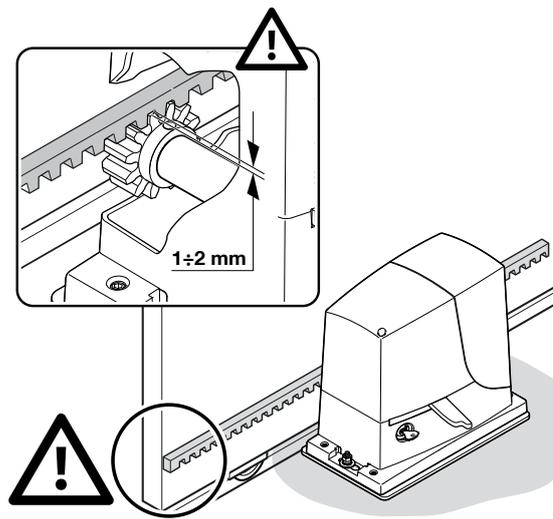
m - передвинуть ручную створку, используя шестерню, как контрольную точку для закрепления других элементов зубчатой рейки
