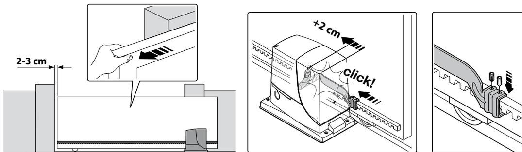
**09. Вручную закрепить электропривод**
