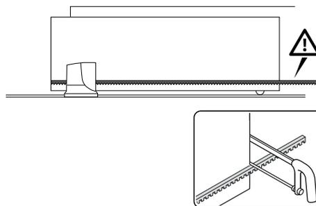
06. Вручную перевести створку в положения Открытия и Закрытия, чтобы проверить, что зубчатая рейка выровнена относительно шестерни.
