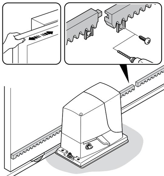
n - затем отрезать оставшуюся часть зубчатой рейки
