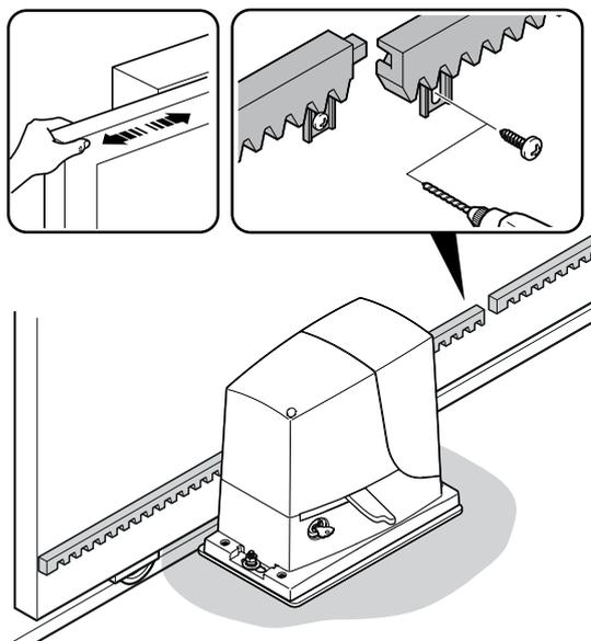
n - при необходимости отрежьте лишнюю часть на конце зубчатой рейки
