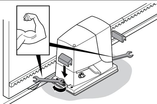
08. Закрепите кронштейны концевых выключателей ОТКРЫТИЯ и ЗАКРЫТИЯ: для обоих кронштейнов концевых выключателей выполняются аналогичные операции
