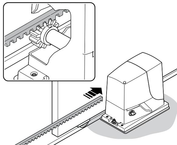
l - прикрепите элемент зубчатой рейки
