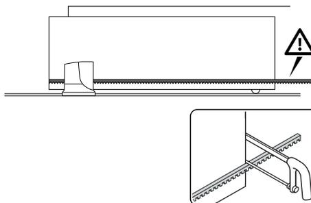
06. Вручную переместите створку в положения открытия и закрытия, чтобы убедиться в параллельном движении зубчатой рейки относительно шестерни.
