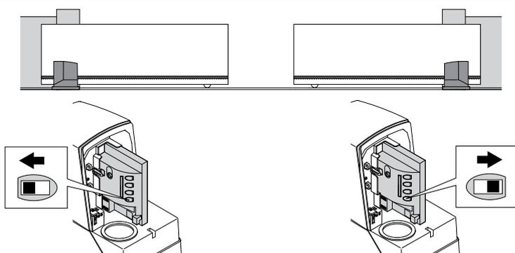
Не важно, какой из двух двигателей работает в качестве «Ведущего» и какой - «Ведомого»; при выборе следует учесть удобство соединений и тот факт, что команда «Пошаговый режим» обеспечивает полное открывание только створки, управляемой устройством «Ведомый»
