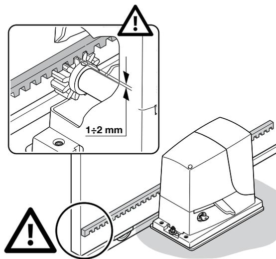
m - вручную сдвиньте створку и, используя шестерню как контрольную точку, закрепите другие элементы зубчатой рейки
