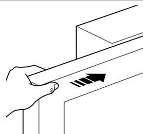
i - установите на шестерню электропривода первый элемент зубчатой рейки: проверьте, чтобы она совпадала с началом створки и чтобы между шестерней и зубчатой рейкой имелся зазор  $1 \div 2$  мм (во избежание воздействия веса створки на электропривод)
