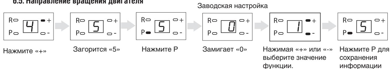
**Значение «0»** – вверх полотно движется против часовой стрелке – вниз полотно движется по часовой стрелке
