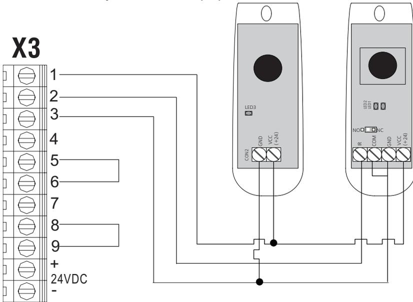
**Схема подключения оптических датчиков OPTOKIT (Y3)**
