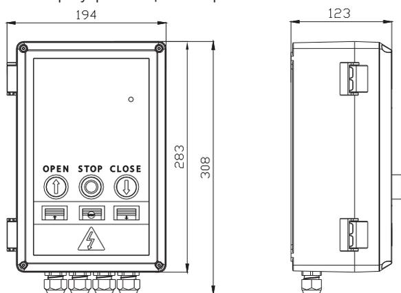
2. Закрепите управляющий шкаф на стене на расстоянии 1,7 м от поверхности пола.
