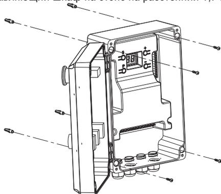
3. Конструкция управляющего шкафа
