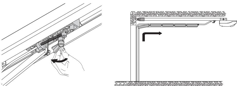
Установите механический упор вплотную к тележке и зафиксируйте его.
