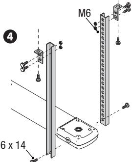
Просверлите отверстия в потолке напротив крепежных отверстий кронштейнов и зафиксируйте последние подходящими болтами и дюбелями.
