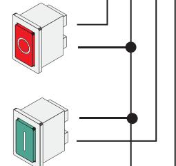
Функция "ЧАСТИЧНОЕ ОТКРЫВАНИЕ" с помощью устройства управления (Н.О. контакты).
