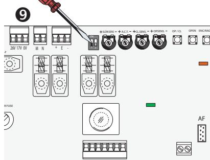
С помощью кнопки "OP/CL" закройте и откроите ворота, чтобы проверить успешность выполнения процедуры программирования.
