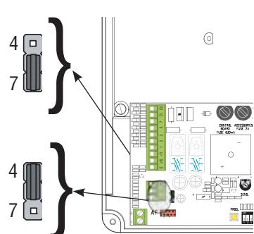
Функция «ТОЛЬКО ЗАКРЫТЬ» с помощью устройства управления (нормально-разомкнутые контакты). Внимание: в режиме «ПРИСУТСТВИЕ ОПЕРАТОРА» необходимо обязательно подключить устройство управления к контактам 2-4.
