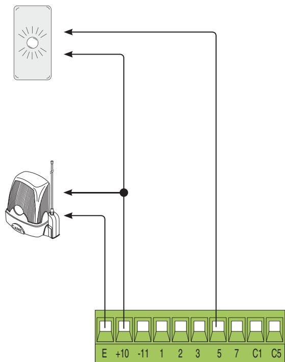
Сигнальная лампа (макс. нагрузка контактов: 24 В, 32 Вт макс.).
