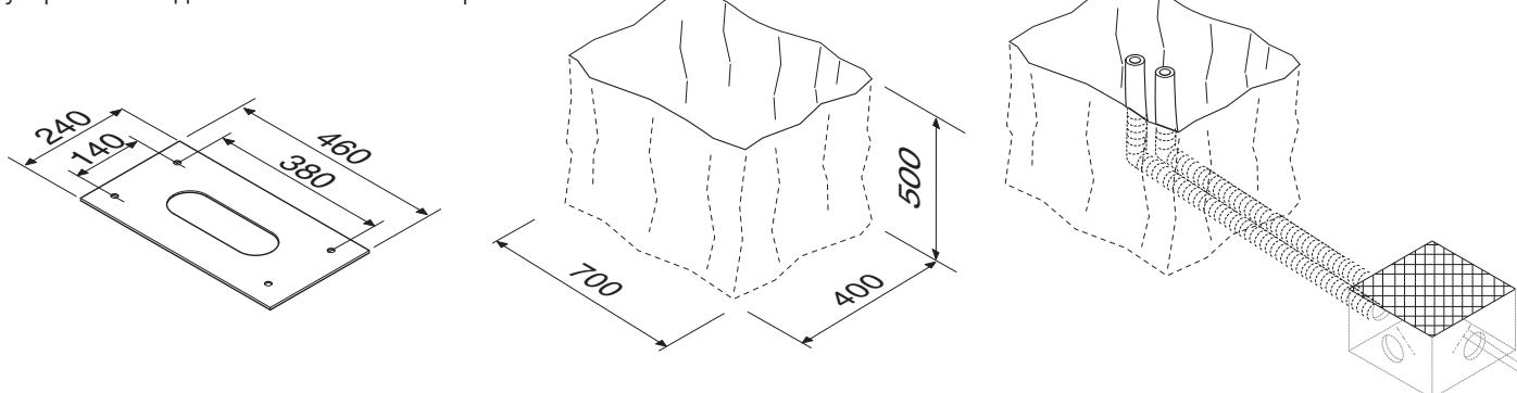
Подготовьте опалубку большего, чем монтажное основание, размера и установите ее в яму.
