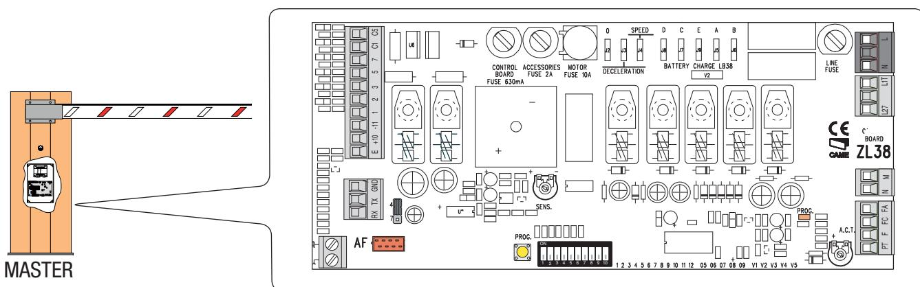
На ВЕДОМОМ блоке управления подключите электропитание к контактам L-N, сигнальную лампу к 10-E; установите DIP 7 в положение ON и отрегулируйте скорость движения и замедления, как показано на блоке управления ВЕДУЩЕГО шлагбаума.
