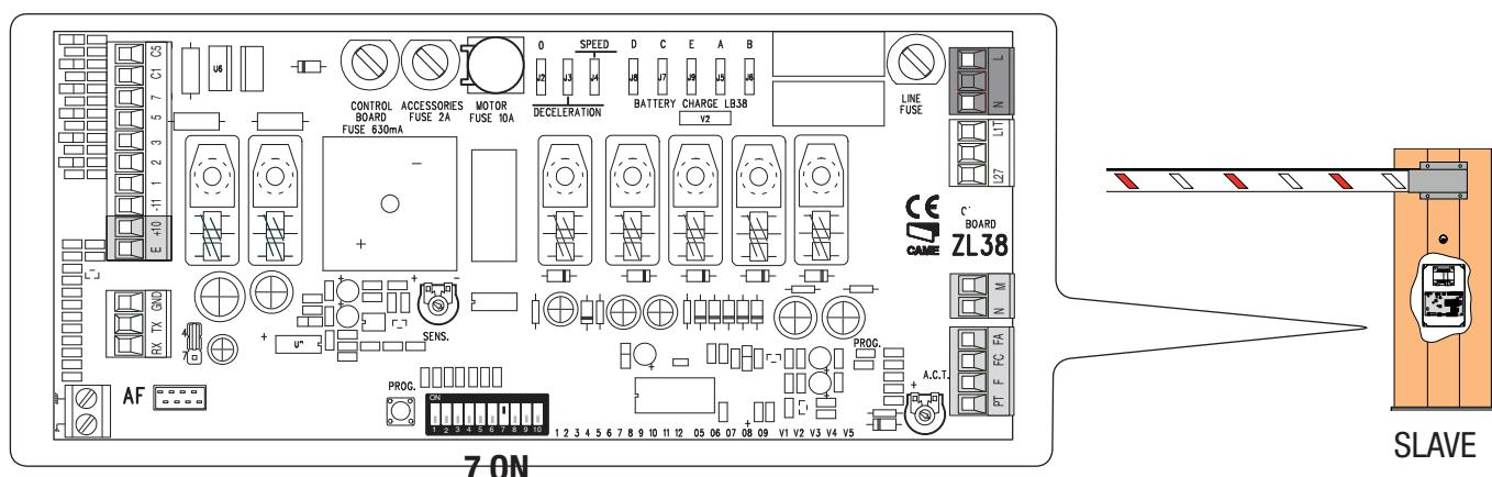
Подключите блоки управления так, как показано на рисунке, используя контакты RX-TX-GND.
