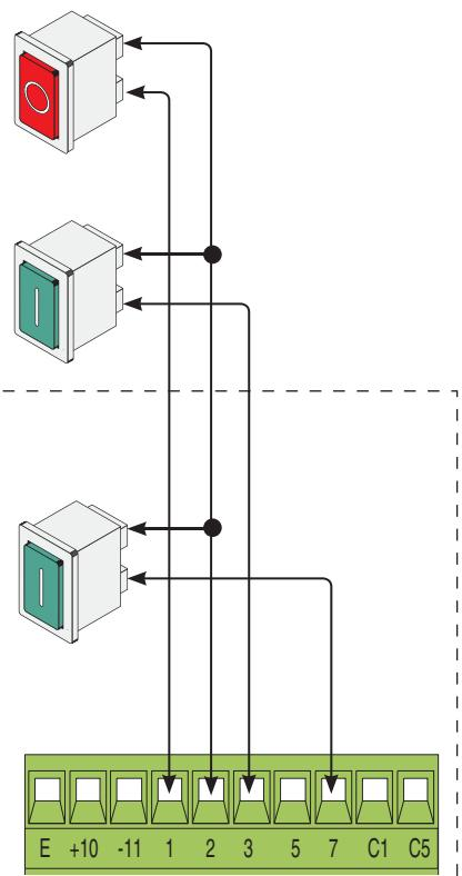
Функция «ТОЛЬКО ОТКРЫТЬ» или «ОТКРЫТЬ-ЗАКРЫТЬ-ИЗМЕНИТЬ НАПРАВЛЕНИЕ» (пошаговый режим) с помощью устройства управления (нормально-разомкнутые контакты), см DIP 2.
