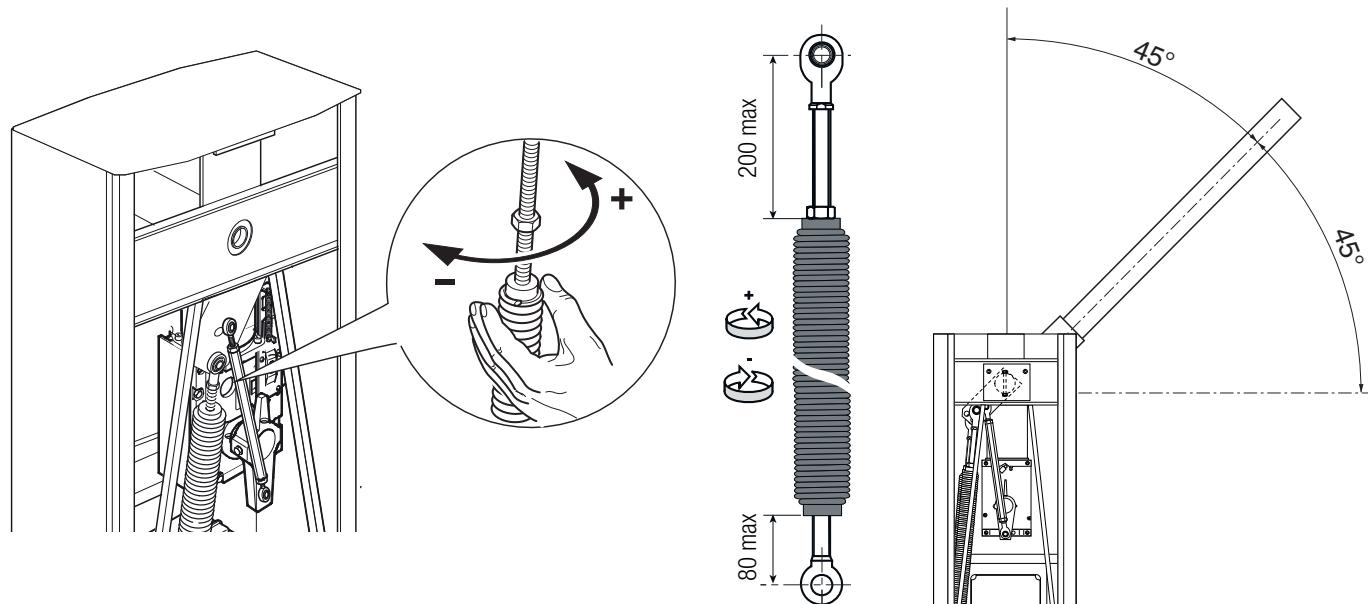
Установите крепежную гайку на верхнее крепление пружины и затяните ее.
